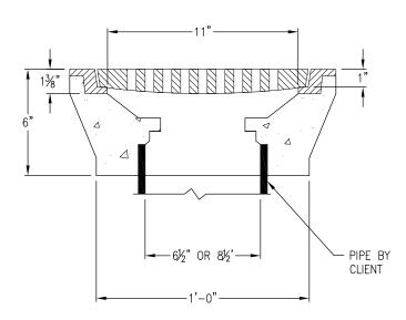
6"Ø RBT DRAIN WEIGHT: 45LBS. 8"Ø RBT DRAIN WEIGHT: 45LBS.
